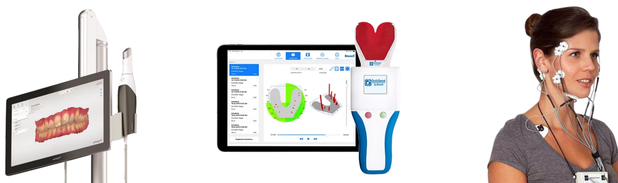
Fig.5. Outils d'évaluation utilisés dans le protocole : TRIOS® (3Shape) pour les empreintes optiques, OccluSense® (Bausch) pour l'analyse occlusale numérique, et Myotronics® K7 pour l'électromyographie de surface.
