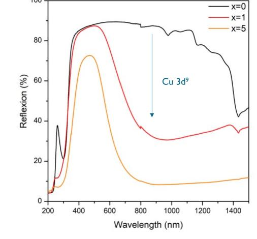
La réflexion diffuse montre que l'absorption du rayonnement laser augmente linéairement avec la teneur en cuivre (1 à 5 mol %) incorporée dans la matrice d'HAp, en raison des transitions électroniques d-d des ions Cu<sup>2+</sup>.
