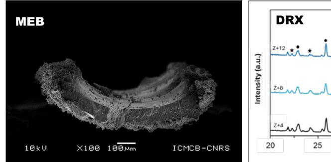
au laser induit une densification de la surface à des températures supérieures à 1125 °C.
