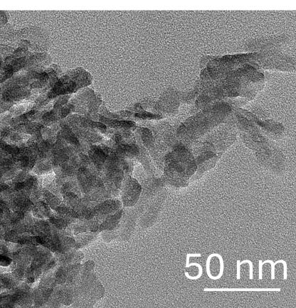
Les DRX et la micrographie TEM montrent les cristallites anisotropes en forme de bâtonnets d'une longueur d'environ 40-50 nm
