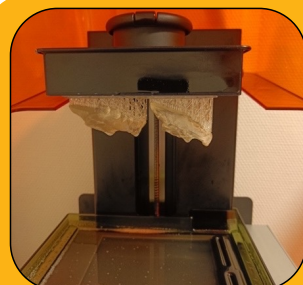
5a) Impression Résine : Formlabs Dental LT clear® Imprimante : Form 2 Formlabs
