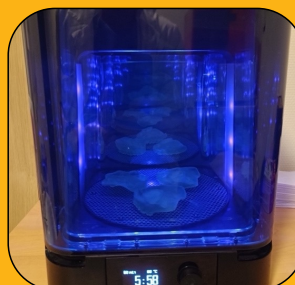
5c) Post-polymérisation pendant 60 minutes avec le système Form Cure®
