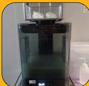
5b) Rinçage à l'alcool isopropylique pendant 15 minutes à l'aide de la Form wash®
